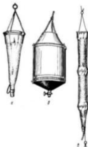
Рис. 16. Приспособления для отбора проб зоопланктона (по Березиной Н.А., 1989). Качественные планктонные сети: а - сеть Апштейна; б - сеть Липина в закрытом и открытом виде; в — цилиндрическая сеть "Цепелин"
