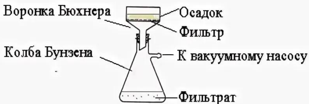
Рис. 4. Установка для фильтрования под вакуумом
