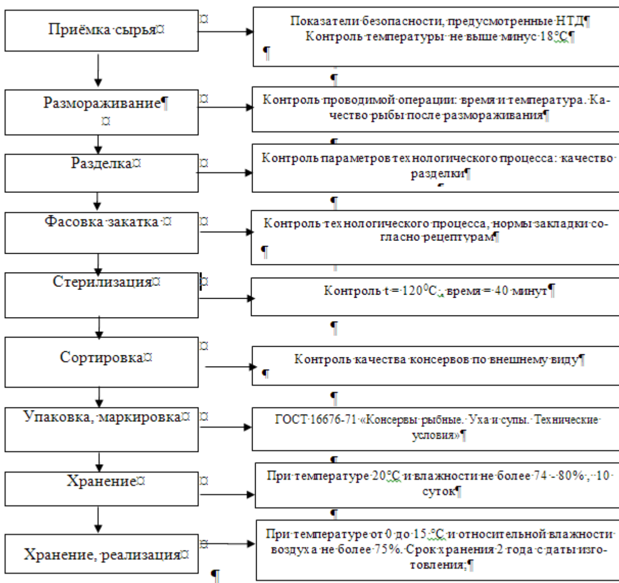
Рисунок 2 – Блок-схема процессной диаграммы для разработки технологической линии производства консервов «Уха «Атлантика»
