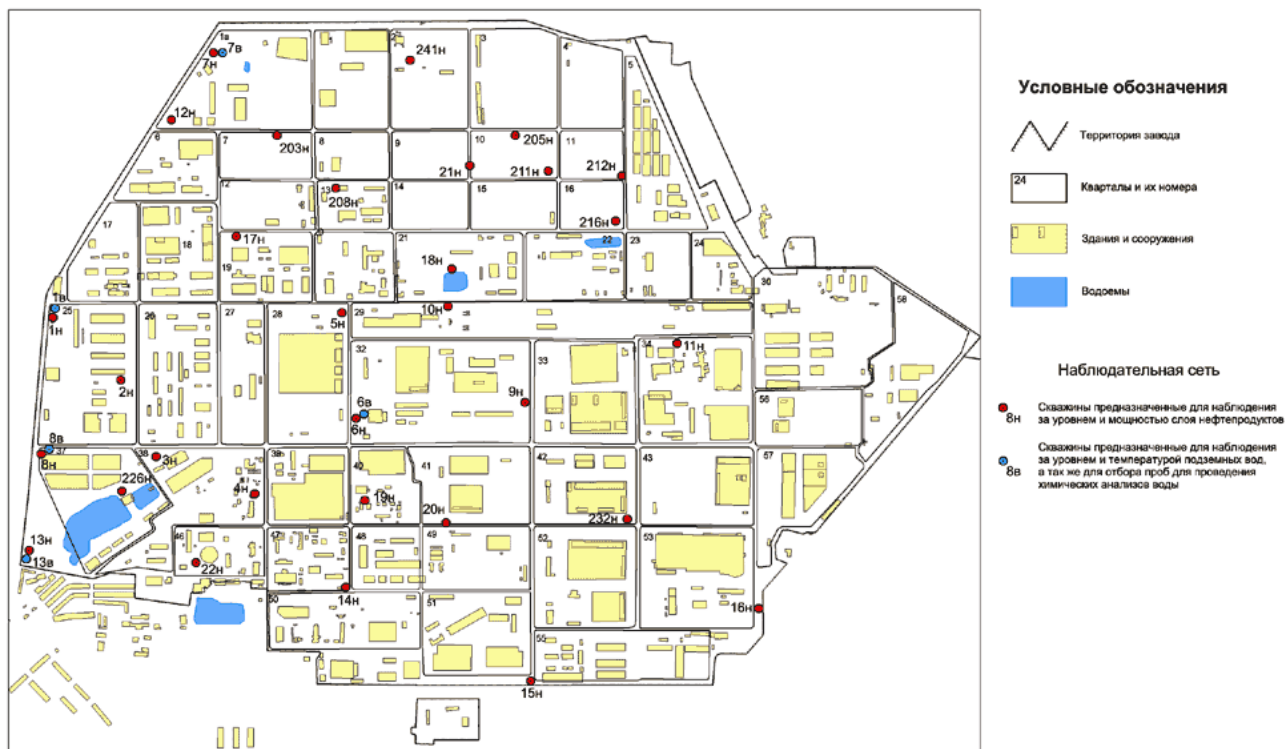
Рисунок 1 – Схематический план наблюдательной сети на территории Московского НПЗ
